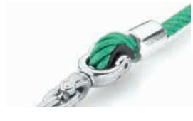
Piñón de cadena dedal acero inoxidable Art. No. 4603-20 giratorio con cojinete de bronce resistente al desgaste para una carga de torsión máxima de cadena de 6 mm u 8 mm en cuerda Hércules Ø 16 mm
