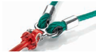
Grillete de 2 ojales, acero inoxidable incluido perno transversal M10 Art. No. 440-10 sin apoyo, ideal para la formación de esquinas con horizontal redes, para cuerda Hércules Ø 16 mm o Ø 18 mm, también disponibles como grillete de 3 ojales, incl. perno transversal M8
